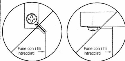
**Prevenzione** Attaccando l’occhiello come mostrato in figura si localizzano forze di taglio sulla fune che possono causare un cedimento a fatica anticipato. Quindi, per evitare la prematura rottura della fune, evitare le condizioni di montaggio mostrate in figura.
