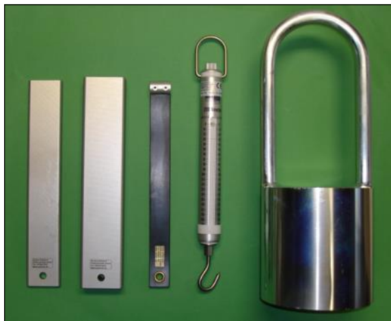
Asta di misurazione 1 (10 mm x 50 mm) Asta di misurazione 2 (30 mm x 60 mm) Asta di misurazione 3 Dinamometro a molla Asta di misurazione 4
