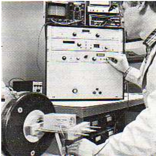
Fig.8 – Vibratore elettrodinamico per la calibrazione di un accelerometro
