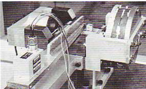
Fig.11 – Braccio basculante collegato ad un vibratore
