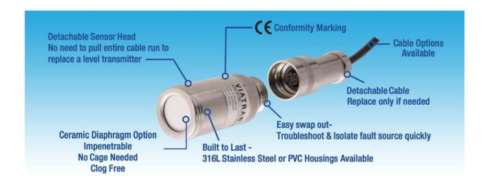
I trasmettitori di livello con connessione elettrica a connettore serie DLT <sup>™</sup> consentono, in modo rapido, lo scambio del sensore senza rimozione dell'intera tratta di cavo istallato nell'impianto.
