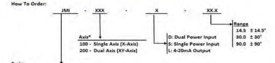
JMI - Analog MEMS Inclinometer
