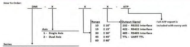
DMI - Digital MEMS Inclinometer
