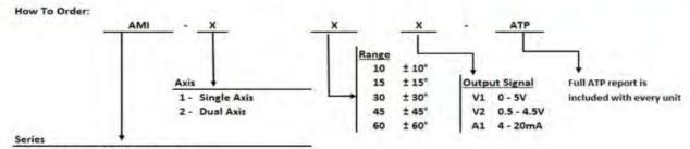
AMI - Analog MEMS Inclinometer
