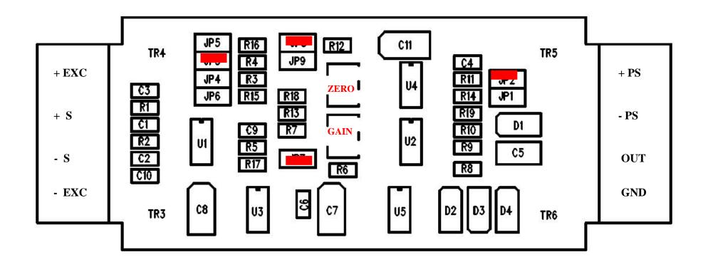
Esempio di CONFIGURAZIONE : Alimentazione al ponte +5 Vdc ; Uscita +/- 5 V @ +/- 2 mV/V nom
