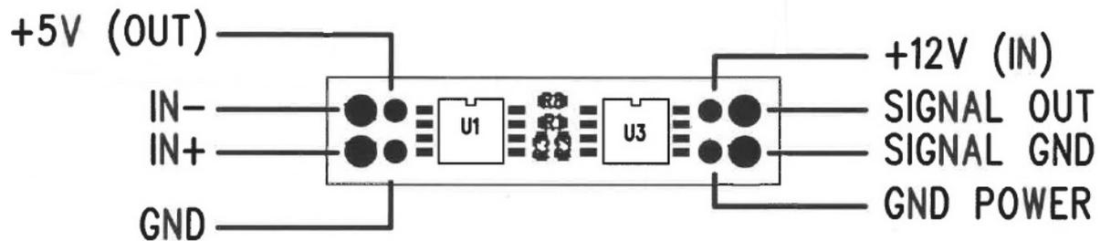
Il condizionatore estensimetrico, se fornito montato (in configurazione Kit) ha il Pin Out :
