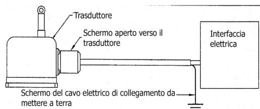
**Cavo elettrico schermato** Si raccomanda di usare un cavo schermato con i fili attorcigliati per il collegamento elettrico tra il trasduttore e l’interfaccia di condizionamento. Lo schermo dovrà rimanere libero dalla parte del trasduttore e portato a terra dal lato opposto, come mostrato in figura.
