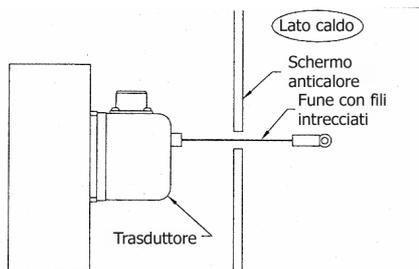
Nelle applicazioni dove il calore radiante può aumentare la temperatura del trasduttore rispetto ai suoi limiti di funzionamento, è consigliabile interporre uno schermo tra l'area calda ed il trasduttore, come mostrato in figura.
