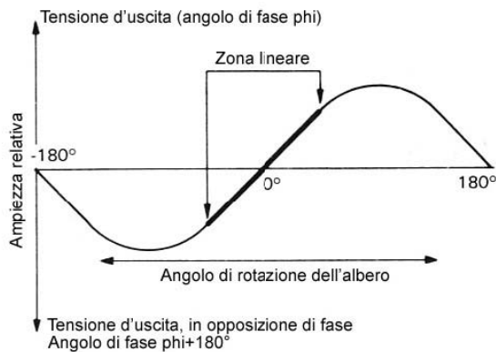
fig. 3.5 Caratteristica d'uscita di un RVDT
